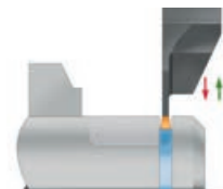
① Радиальное врезание ② Отвод на 0,1 мм
