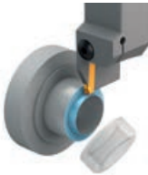
Пластина левого исполнения: заусенец слева на трубе
